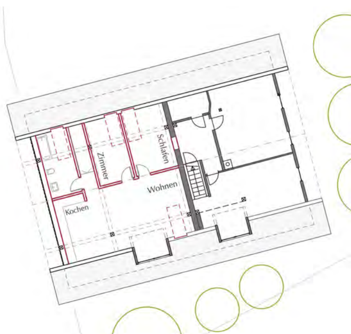
Grundriss Dachgeschoss: neue WE/ Wohnung
